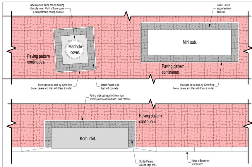
PAVE05 TYPICAL PAVING AROUND SERVICES DETAIL 1:25
